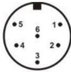
Sicht auf Lötseite Stecker Sicht auf Lötseite Stecker
